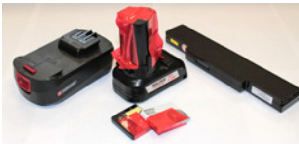
Foto: Bei Lithium-Ionenbatterien Pole abkleben
